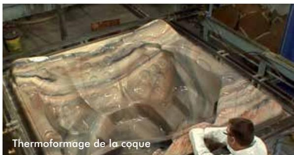
Thermoformage de la coque
