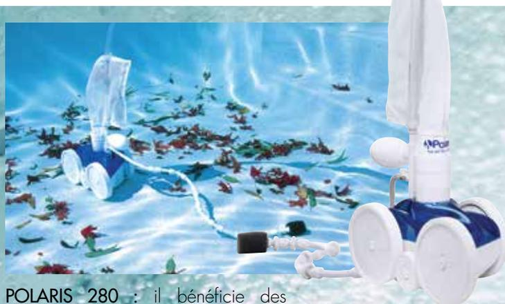
**POLARIS 280** : il bénéficie des dernières évolutions technologiques. Son système de transmission lui permet de se déplacer rapidement partout. Les 2 jets disposés face à face créent un effet venturi homogène qui permet à l'appareil d'adhérer au sol de manière optimale et d'augmenter ses performances de nettoyage.
