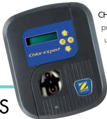
**CHLOR EXPERT** : Intègre la technologie du dosage proportionnel afin de maintenir automatiquement un niveau de chlore idéal pour le confort des baigneurs. C'est la méthode « Redox » qui est utilisée, autrement dit la mesure de la « capacité désinfectante de l'eau ».
