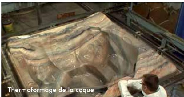
Thermoformage de la coque
