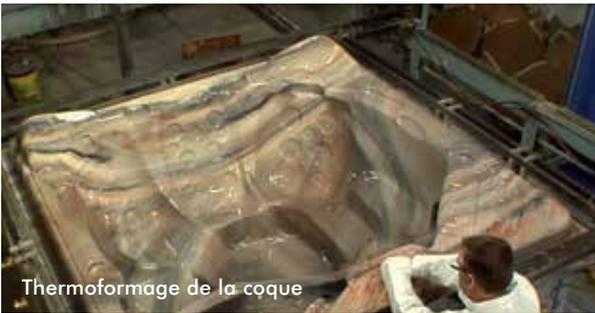
Thermoformage de la coque
