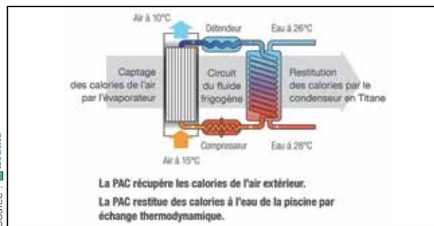
Une pompe à chaleur est un **appareil thermodynamique**. Son principe de fonctionnement est très simple : l'appareil capte dans l'air les calories pour les restituer directement dans l'eau du bassin.
