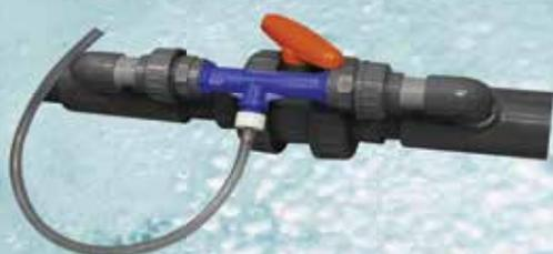
**DÉCHLORINATEUR-VENTURI, EAUX DE CONTRE-LAVAGE, BWT** : Le système est très simple et rapide à installer sur n'importe quel filtre. Il vient se greffer sur la mise à l'égoût de celui-ci. Lors du nettoyage ou de la vidange de la piscine, l'eau chlorée rejetée est mélangée à un neutralisant par un système de venturi, afin de rejeter une eau non chlorée à l'égoût. Cette "eau neutre" peut être stockée et convenir à l'arrosage du jardin ou au lavage de la voiture.
