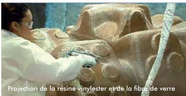
Projection de la résine vinyloxy et de la fibre de verre
