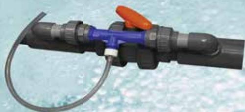
**DÉCHLORINATEUR-VENTURI, EAUX DE CONTRE-LAVAGE, BWT** : Le système est très simple et rapide à installer sur n'importe quel filtre. Il vient se greffer sur la mise à l'égout de celui-ci. Lors du nettoyage ou de la vidange de la piscine, l'eau chlorée rejetée est mélangée à un neutralisant par un système de venturi, afin de rejeter une eau non chlorée à l'égout. Cette "eau neutre" peut être stockée et convenir à l'arrosage du jardin ou au lavage de la voiture.
