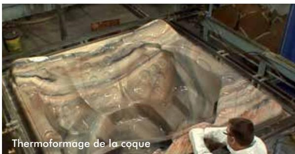
Thermoformage de la coque
